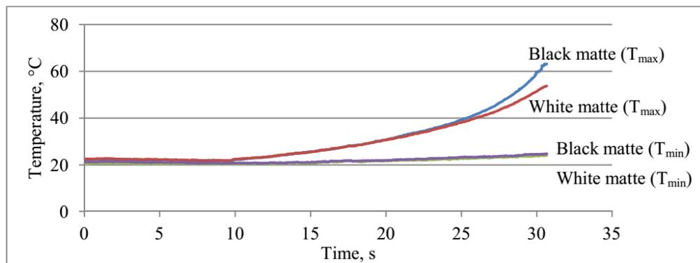
**Slika 3.** Izmjerene promjene temperature kod crnog mat i bijelog mat premaza
