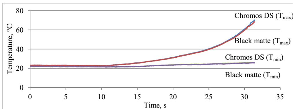
**Slika 4.** Izmjerene promjene temperature kod crnog mat premaza i Chromos DS MASK premaza
